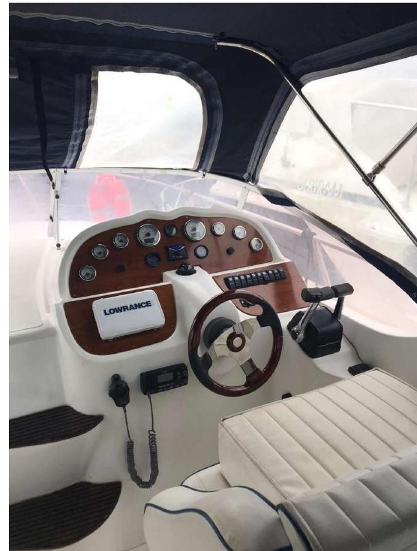
La zona prodiera è completa, con la strumentazione analogica dei motori, con controllo EVC Volvo Penta, la barca dispone di bussola, GPS Plotter Lowrance HDS 7 a colori, il VHF è Cobra Marine.
