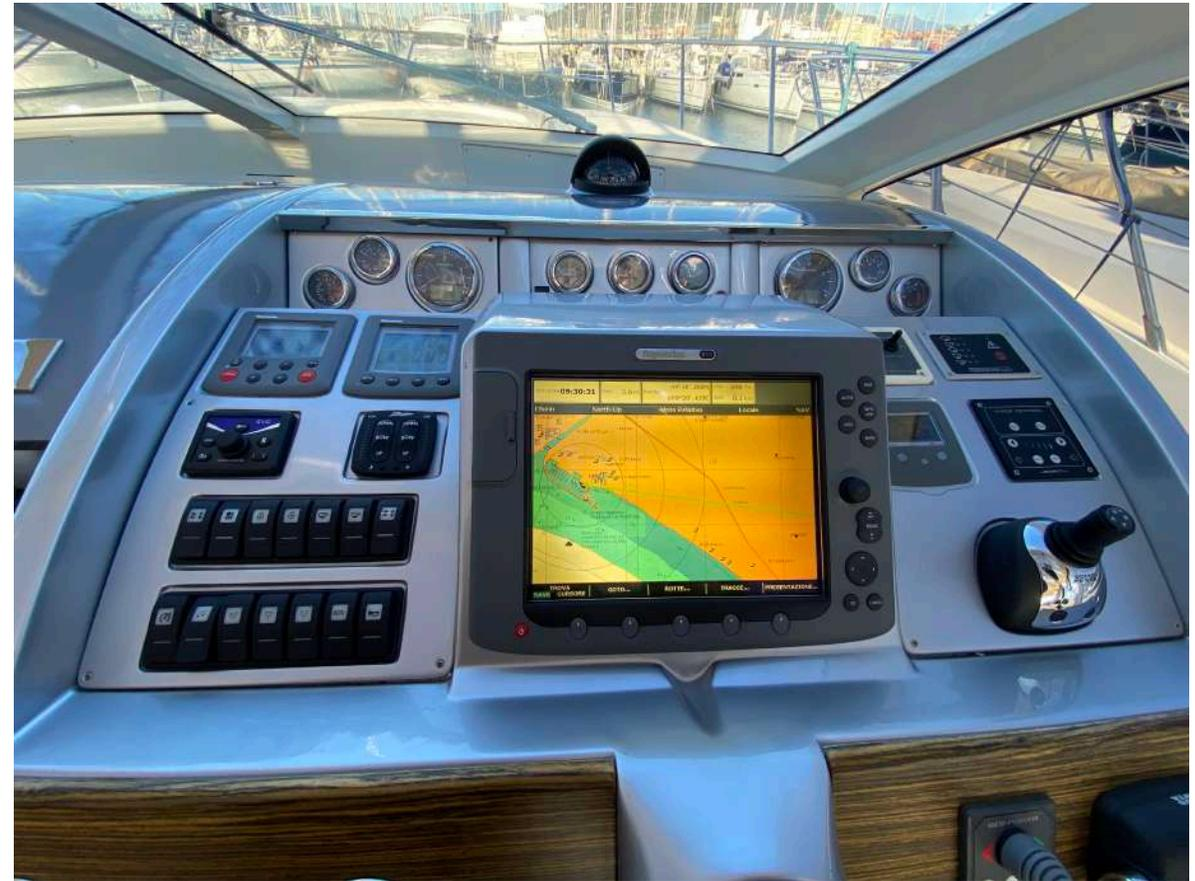
La zona prodiera è completa anche di elica di prua, l'elettronica annovera GPS Raymarine E 120, autopilota Raymarine, Tridata. Il Contacatena digitale è Quick. La barca oltre alle manette elettroniche ed EVC, ha il Joystick di manovra.
